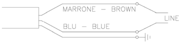
Figura 1: Schema di collegamento per motore 4" serie TW Figure 1: Wiring diagram for motor 4" TW series Figure 1: Schéma de connexion pour moteur 4" série TW Rysunek 1: Schemat podłączenia dla silnika 4" serii TW
